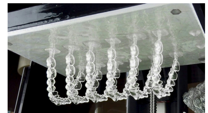
Obrázok 4: Priama 3D tlač alignerov sialolitografickou metódou (19)
