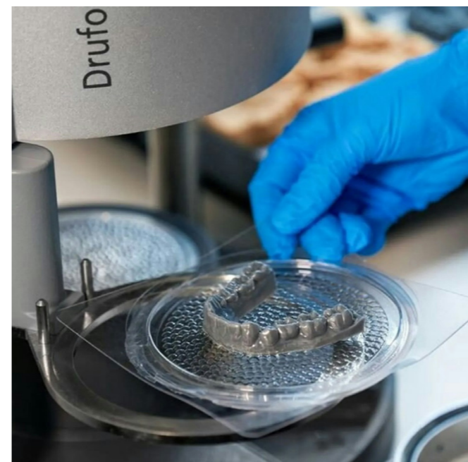
Obrázok 2: Tvarovanie termoplastickej fólie cez 3D model (21)
